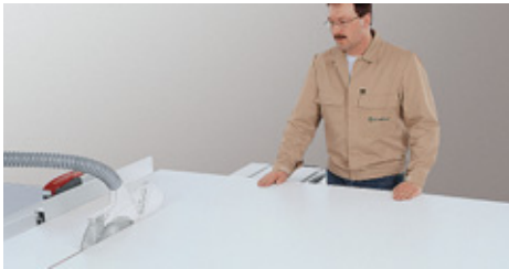
Plattenstreifen am Parallelanschlag aufschneiden.
