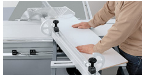
Gehrungsschnitt mit Winkel-Gehrungsanschlag.
