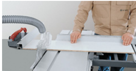
Plattenstreifen am Parallelanschlag auf Fertiglänge schneiden.
