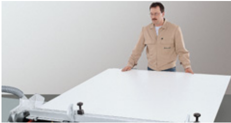
Die Platte ausrichten und einen Besäumschnitt durchführen.
