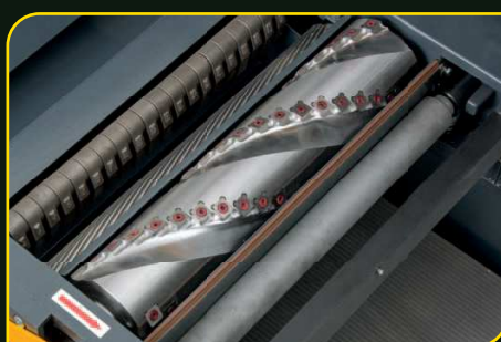
Spiral cutterblock with feeding rollers Spiralmesserwelle mit Vorschubrollen
