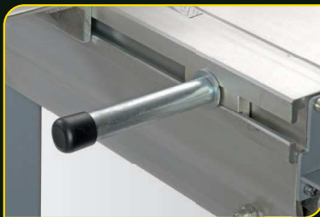
Push lever for sliding table Griff für Alu-Schiebetisch
