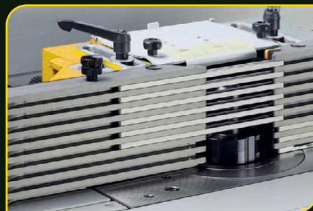
Integral fence AIGNER Fräsenschutz Integralanschlag AIGNER
