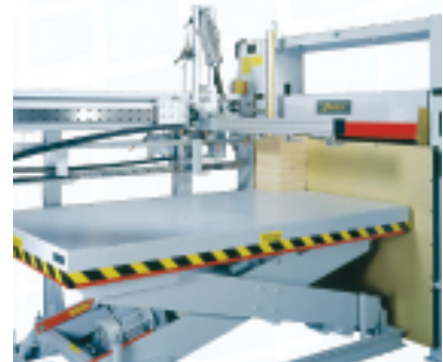
Automatische Materialzuführung mit Einschubvorrichtung Automatic feeding station with pushing device
