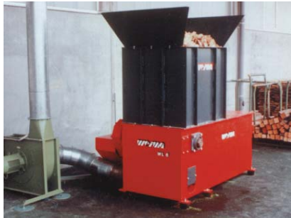
Zerkleinerer der Baureihe WL 6, an eine Absauganlage angeschlossen
