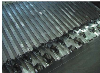
Segmentboden, für sehr dünnes Material (z. B. Furnier)
