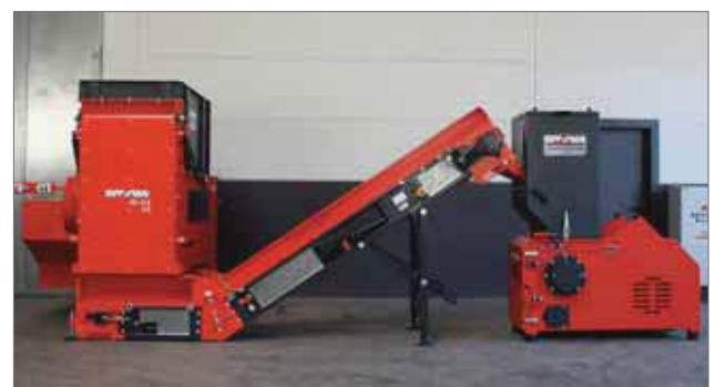
Effektiver, verschleißärmer, leiser: zweistufige Zerkleinerung mit WLK und WNZ.
