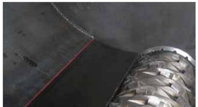
Damit alles reibungslos läuft: der Pipespacer verhindert Brückenbildung.
