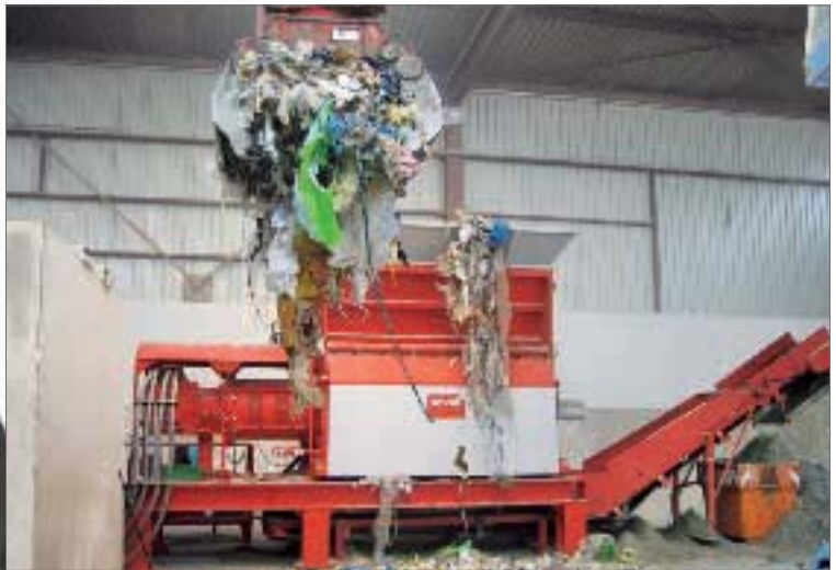
Stark im Nehmen: Beschickung der PreCut durch einen Greifer.
