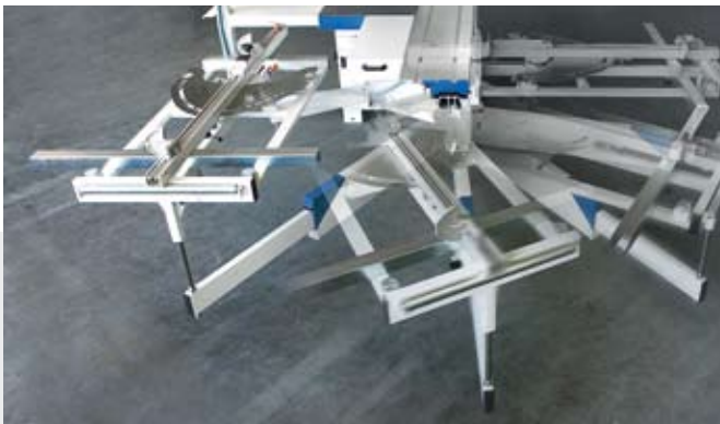
Wegschwenkvorrichtung für Querschleifen • Swing away device for cross carriage • Equipo abatible para la bandera
