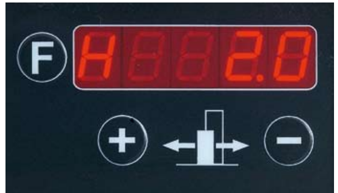
Positioniersteuerung Vorritzaggregat Höhe und Seite • Positioning control for scoring unit vertical and lateral • Mando de posición para el incisor vertical y lateral
