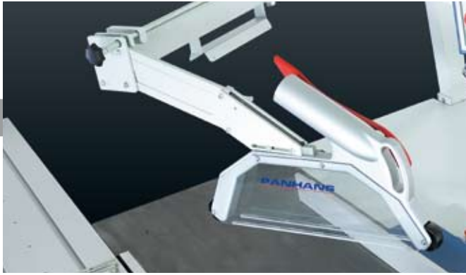
Schutzhaube wegschwenkbar • Protection cover tiltable • Cubierta de protección girable
