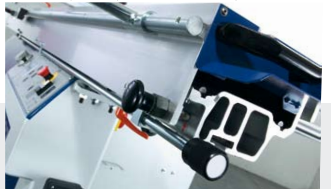
Fernarretierung für Rollwagen • Remote locking of sliding table • Sujeción a distancia para el carro
