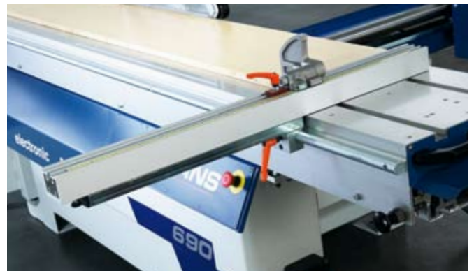
Parallelanschlag links vom Sägeblatt • Parallel fence to the left of the saw blade • Tope paralelo a la izquierda del disco de sierra
