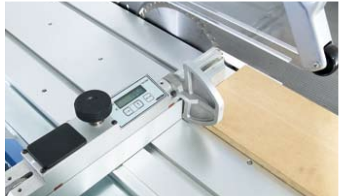
Tele-Digit, digitale, kabellose Maßanzeige für Längenanschlag • Tele-Digit, digital and wireless indication of measure for fence for cutting to length • Tele-Digit, indicación digital sin cable para el tope longitudinal
