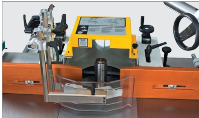
S Profilovací kryt frézky • Safety protection for profiles Profilschutzhaube • Protección de seguridad para profiles Guide pour le travail à l'arbre • Профильный кожух
