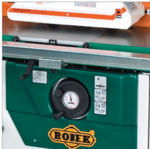
S Zdvih vřetena • Spindle stroke Spindelhub • Recorrido del eje Course de l'arbre • Ход шпиделя
