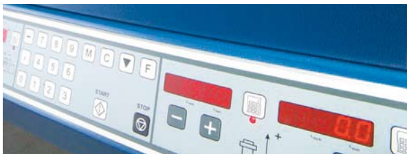
Logik-Positioniersteuerung für Höhen-/Schwenkverstellung d. Frässpindel
